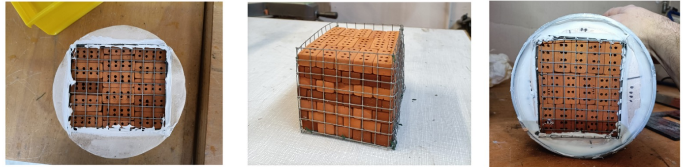
Fig 12. Massif utilisé pour les essais de conductivité hydraulique
