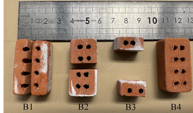
Fig 10. Blocs utilisés pour la construction des murs
