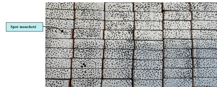
Fig 19. Spots réalisés pour le suivi des déplacements par le DIC
