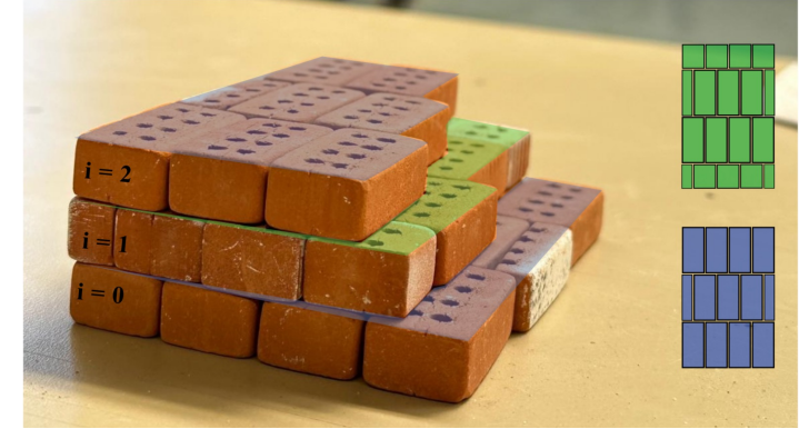
Fig 11. Assemblage considéré pour la construction du mur
